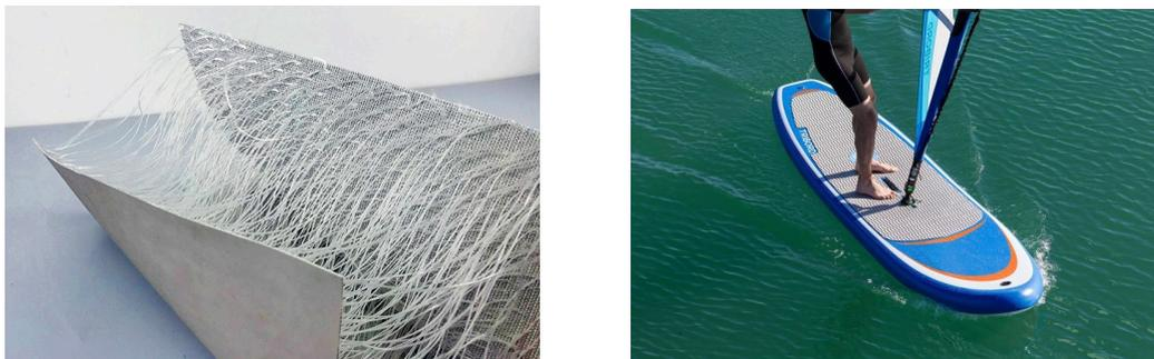
FIGURE 1 – (gauche) Matériau *drop-stitch* utilisé pour fabriquer les plaques gonflables. (droite) Exemple commercial d'application des panneaux gonflables aux loisirs (copyright Decathlon).
